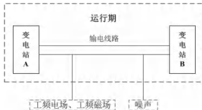
图 4-4 输电线路运行期产污环节
