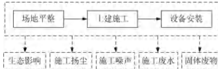
图 4-1 变电站建设期产污环节
